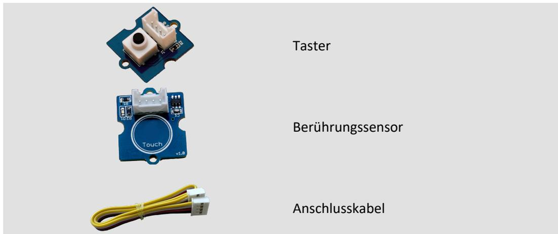
Taster und digitale Sensoren werden an die digitalen Ein-/Ausgänge angeschlossen (*Digital Input/Output D2, D3, ..., D8*).
