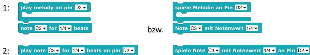
Hier werden der Pin, an den der Summer angeschlossen ist, und die zu sendenden Noten mit den entsprechenden Notenwerten eingetragen (*siehe unten*).
