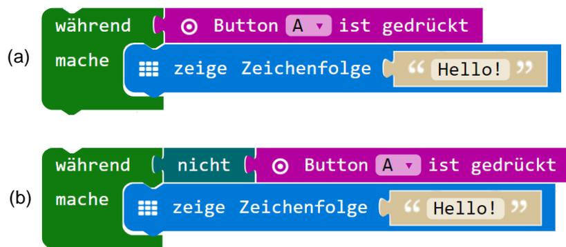
Abbildung 36 – Die Abbruchbedingung ist abhängig von der Taste A. (a) Wiederhole, solange Taste A gedrückt ist. (b) Wiederhole, bis Taste A gedrückt ist.
