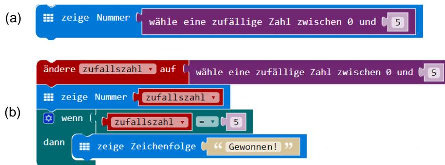
Abbildung 45 – Variablen speichern Werte für den späteren Gebrauch im Programm. (a) Nach der Anzeige auf dem LED-Display hat man keinen Zugriff mehr auf die Zufallszahl. (b) Eine Variable speichert den Wert der Zufallszahl, damit sie später wiederverwendet werden kann.
