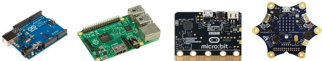
Abbildung 1 – Physical Computing Plattformen (von links nach rechts): Arduino Uno, Raspberry Pi, BBC micro:bit, Calliope mini.
