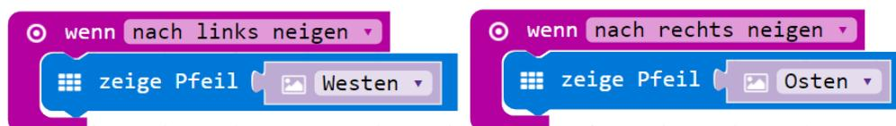
Abbildung 55 – Testen des Lagesensors mit Ereignissen.
