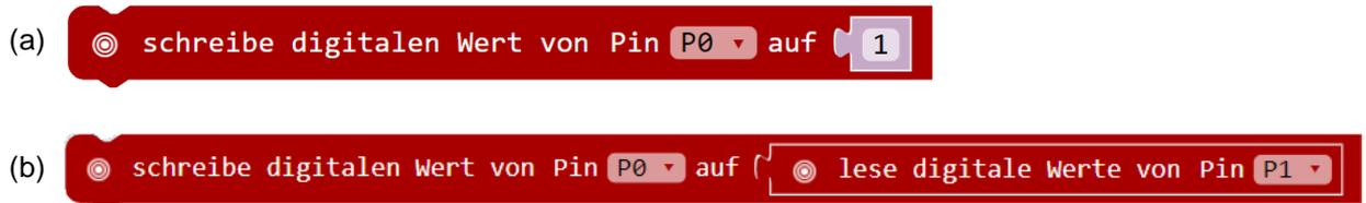
Abbildung 33 - Über Parameter werden Sensoren ausgelesen.
