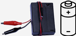
3xAA Batterien (3,6-4,5V) für Motoren (VCC BATT)
