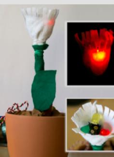
Bei den LED-Modulen handelt es sich um Aktoren, die sowohl binär als auch mittels PWM angesteuert werden können:
