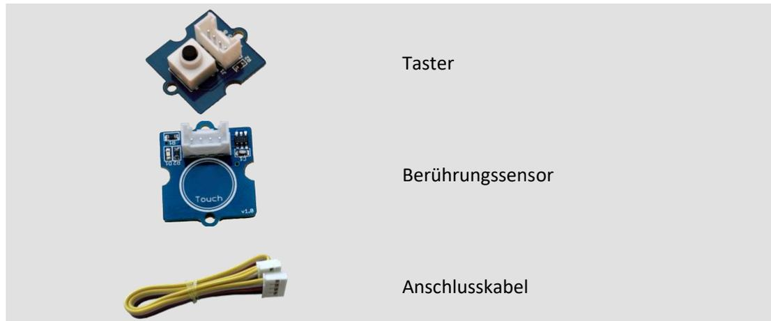
Taster und digitale Sensoren werden an die digitalen Eingänge (*Digital Input/Output* *D2, D3, ..., D8* – im Bild grün umrandet) angeschlossen:
