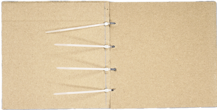
Verbindung mit Kabelbinder
