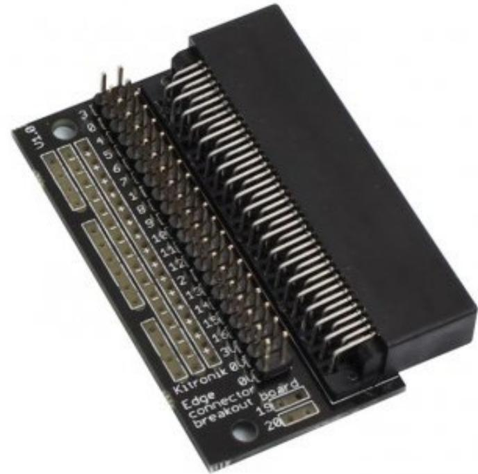
Edge Connector Breakout Board
